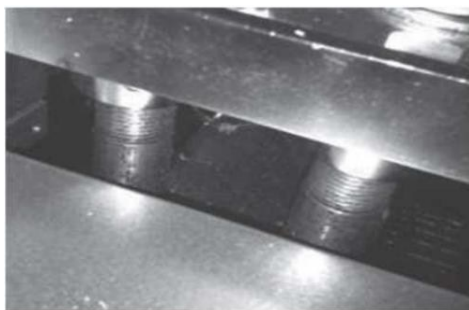
Hình 3.9a. Sự hoen rỉ nhiều vị trí, sợi polime vướng vãi và quần quanh chi tiết
